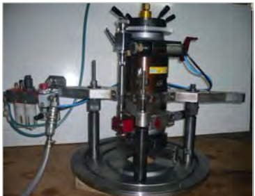
TU SERIES RTJ Planen, Innenbearbeitung und konische Bearbeitung / Facing, Counterboring and conical machining
