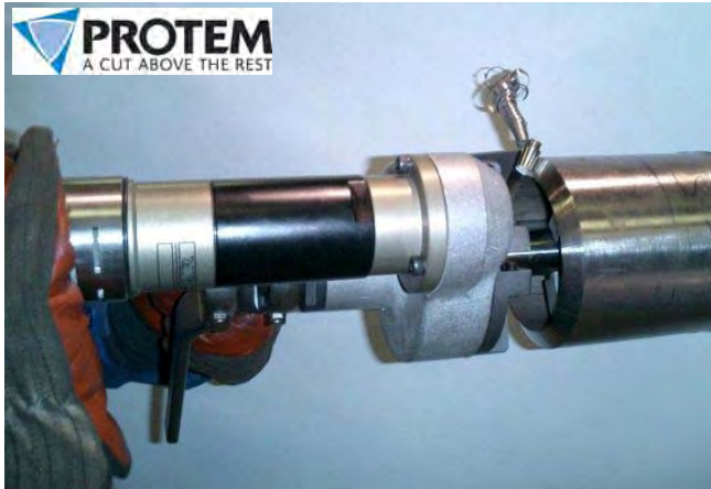
Bild: Option Spannen mit Ratsche Picture: Option clamping with ratchet
