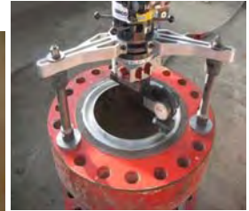
AC38 Bearbeitungswinkel / Angle machining: 0° – 180°
